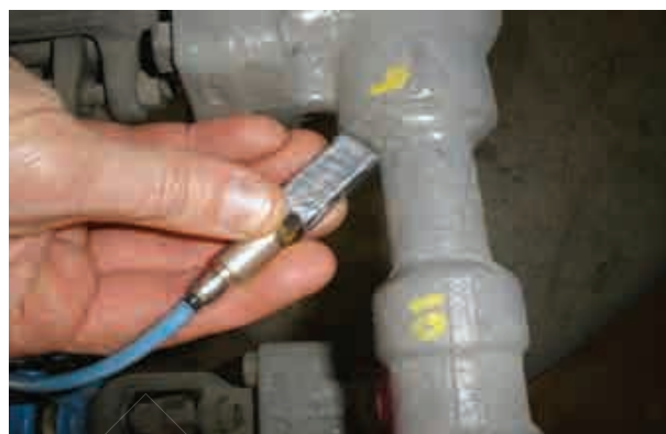
▲ 接口焊缝的检测
