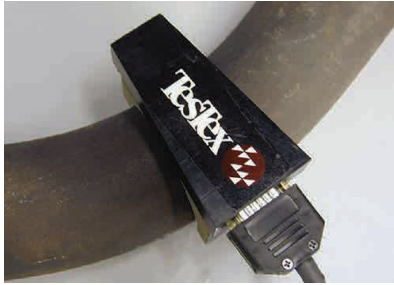
检测弯管内侧的扫查器
