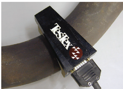
检测弯管内侧的扫查器
