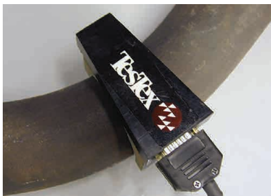
检测弯管内侧的扫查器
